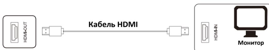
Примечание: интерфейс HDMI – OUT способен передавать аудио- и видеосигналы через разъем HDMI – IN другого устройства. Другое устройство может воспроизводить аудио- и видеосигналы на третьем устройстве и т. д. по «цепочке». Максимальное количество устройств для ретрансляции сигнала зависит от качества и длины кабеля HDMI, поэтому рекомендуется использовать кабели, которые предоставляются нашей компанией.
