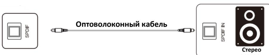
Примечание: этот интерфейс позволяет выводить аудиосигналы интерактивной панели на динамики, оснащенные интерфейсом SPDIF-IN.
