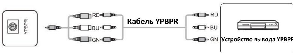
Примечание: тип интерфейса YPBPR – это MINI-порт Ф 3,5 мм. Для подключения сигналов требуется кабель-переходник MINI и кабель YPBPR.
