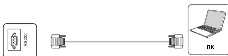
Примечание: разъем RS232-IN подключается к ПК; интерактивной панелью можно управлять с помощью ПК.
