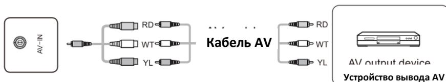
Примечание. Тип интерфейса AV-IN: MINI-порт Ф 3,5 мм. Для подключения сигналов требуется кабель-переходник MINI или адаптер MINI и кабель AV, которые подключаются, как показано на рисунке.
