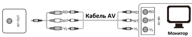
Примечание: тип интерфейса AV-OUT – MINI-порт диам.3,5 мм. Для вывода сигналов требуется кабель-переходник MINI и кабель AV; для передачи сигналов требуется адаптер MINI, который подключается, как показано на рисунке.
